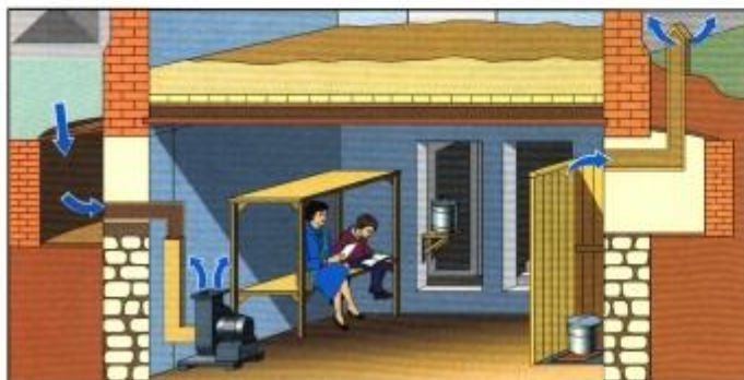
Подвал одноэтажного здания, приспособленный под противорадиационное укрытие
